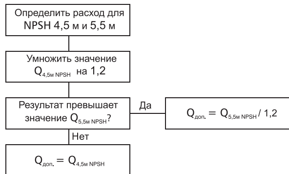
Рис. 10 Обозначение рассчитанного значения Q_{\text{доп}}
